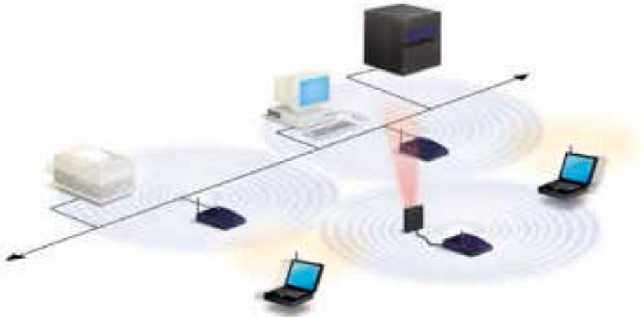
Abbildung 4: Verwendung eines Erweiterungspunktes Ein letzter zu berücksichtigender Bestandteil eines drahtlosen LAN ist die Richtantenne. Nehmen Sie beispielsweise an, Sie haben ein drahtloses LAN in Gebäude A und möchten es zu dem zwei Kilometer entfernten gemieteten Gebäude B erweitern. Eine Lösung ist die Installation einer Richtantenne auf beiden Gebäuden, die jeweils zueinander ausgerichtet sind. Die Antenne auf Gebäude A ist mit dem Drahtnetzwerk über eine Anschlußstelle verbunden. Die Antenne auf Gebäude B ist auf ähnliche Weise mit einer Anschlußstelle in diesem Gebäude verbunden, so daß hier eine drahtlose LAN-Verbindung möglich ist.
