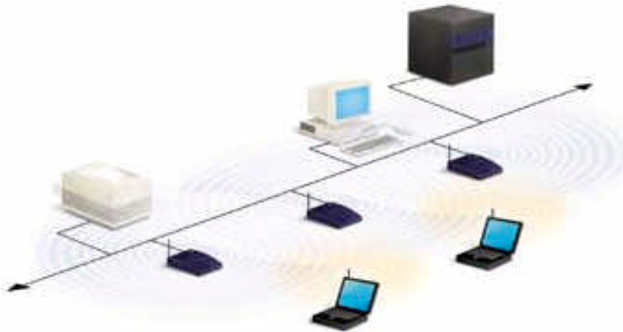
Abbildung 3: Mehrere Anschlußstellen und Verkehrsbereichswchsel Zur Lösung bestimmter Topologieprobleme können die Netzwerkentwickler Erweiterungspunkte (EP) verwenden, um das Netzwerk der Anschlußstellen auszubauen. Erweiterungspunkte sehen aus und funktionieren wie Anschlußstellen, sind jedoch im Gegensatz zu diesen nicht mit dem Drahtnetzwerk verbunden. Erweiterungspunkte erweitern - wie der Name besagt - die Reichweite des Netzwerks durch die Übertragung von Signalen von einem Client an eine Anschlußstelle oder einen anderen Erweiterungspunkt. Erweiterungspunkte können aneinandergereiht werden, um Nachrichten von einer Anschlußstelle an weit entfernte Clients zu übertragen - ähnlich wie eine Menschenkette Wassereimer von einer Wasserquelle zu einem Brand transportiert.
