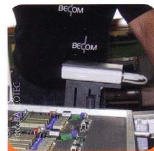
Aus einem Abstand von 15 cm kann die Information des RFID Transponders berührungslos ausgelesen werden.
